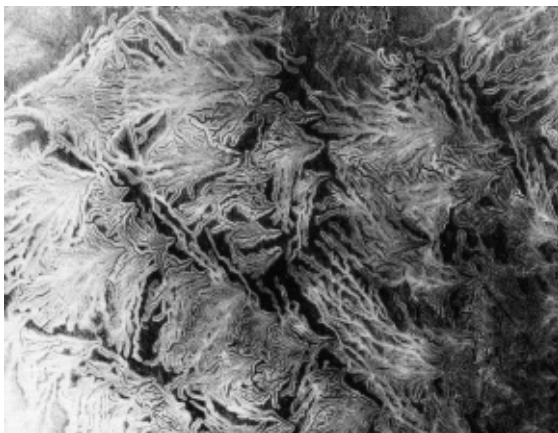
図1 他の物体に密着したあとと分離した高分子材料表面の電荷分布状態 分離時に静電気放電が起こると正負の極性の入り混じった分布になる。分離後に帯電面に電子写真トナーを散布して得られた画像である。
